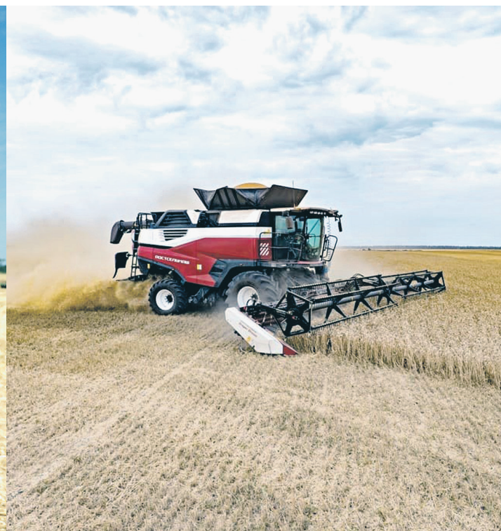
Первый российский зерноуборочный комбайн Н820 8-го класса производительности с уникальной гибридной системой обмолота и сепарации производства «Ростсельмаш».
